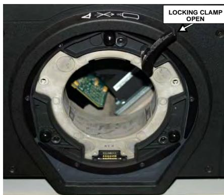
2. Выровняйте выступы и соответствующие выемки на объективе и его гнезде; электрические контакты объектива и соответствующие контакты в гнезде объектива должны быть напротив друг друга.
