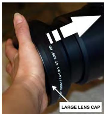
4. Ровно удерживая объектив относительно гнезда, поверните защелку объектива по часовой стрелке, чтобы закрепить объектив.
