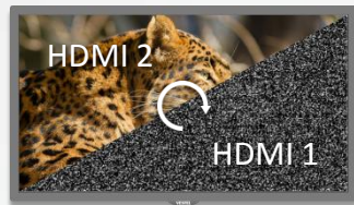
Переключение источника при потере сигнала
