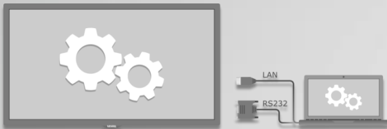
Удаленное управление и настройка по RS232 и LAN
