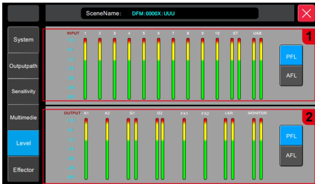
Нажмите кнопку SYSTEM на панели, коснитесь экрана и выберите опцию "Level" слева.
