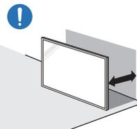
Устройство следует устанавливать на достаточном расстоянии от стены, чтобы обеспечить хорошую вентиляцию.
