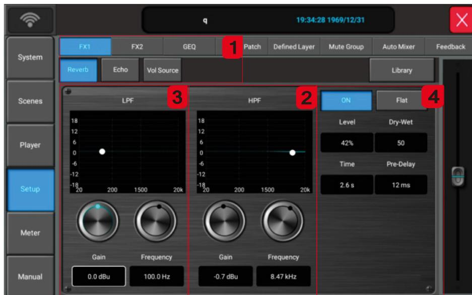
1. **Выбор модуля:** Перейдите на вкладку SETUP в левой части экрана – выберите модуль эффектов 1 (FX1) - модуль реверберации (Reverb).
