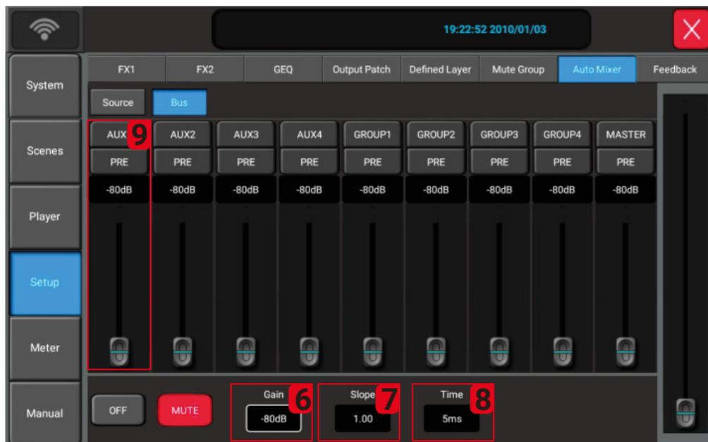
6. **Gain:** Регулировка общего усиления сигнала автоматического микширования (влияет на функцию 9).
