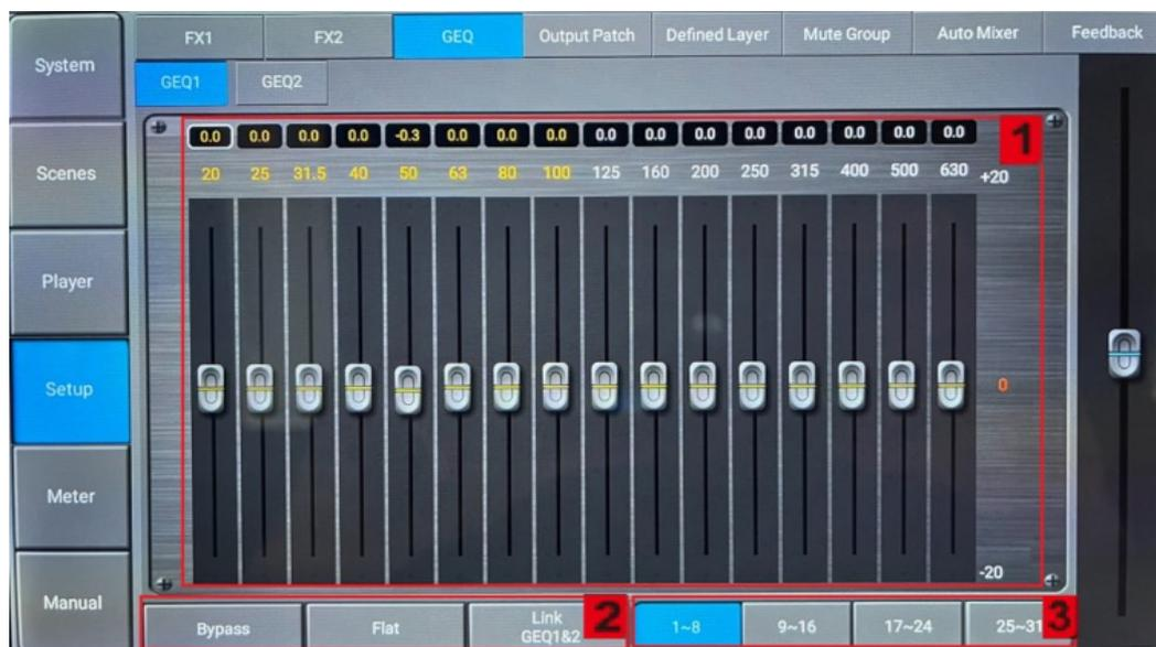
1. **Панель GEQ:** значение усиления, соответствующее каждой частотной точке, по умолчанию равно 0, может быть отрегулировано фейдером соответствующей частотной полосы на экране или физическим фейдером соответствующей частотной полосы.
