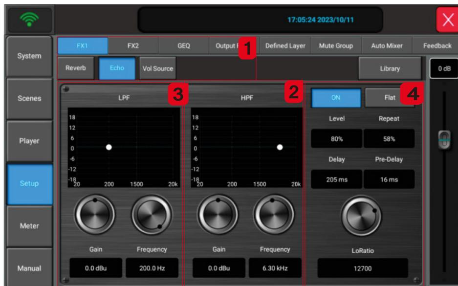
1. Выбор модуля: Нажмите вкладку SETUP слева - Выберите FX1- Модуль Echo.
