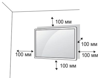
Чтобы установить монитор на стену, прикрепите кронштейн для настенного крепления (дополнительная деталь) к задней части монитора.
